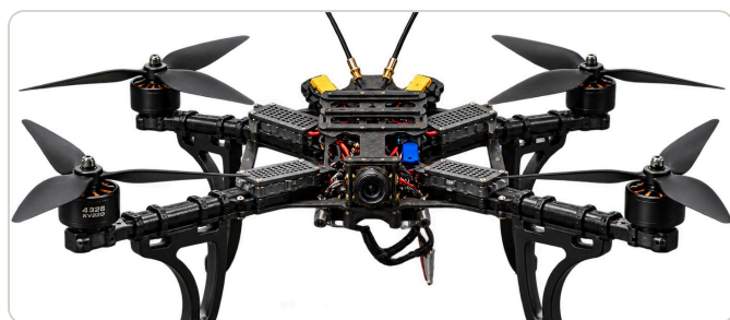
Вигляд спереду: підвіс камери, антени, шасі.
