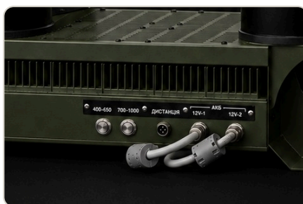
Панель: вмикачі каналів, роз'єм ДИСТАНЦІЯ, вводи АКБ 12V-1 і 12V-2.
